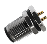
M12 公头面板式，焊接式，前锁安装
